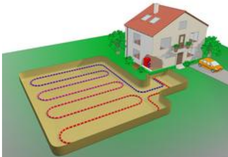
Obr. 4.2.3.3 Využívání zemních kolektorů
