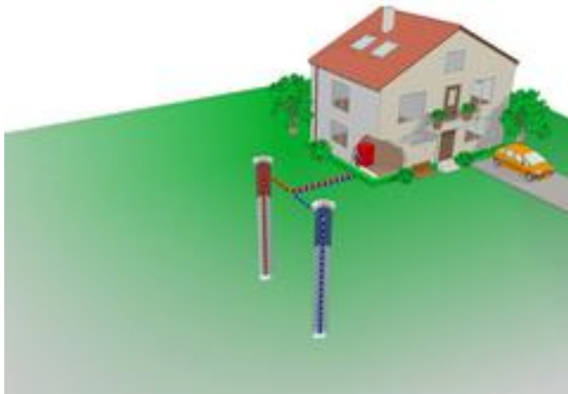
Obr. 4.2.3.2 Využívání tepla spodní vody
