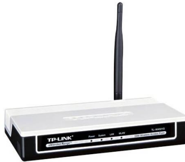
Obr. 5.3.3.1 – Access point (přístupový bod)
